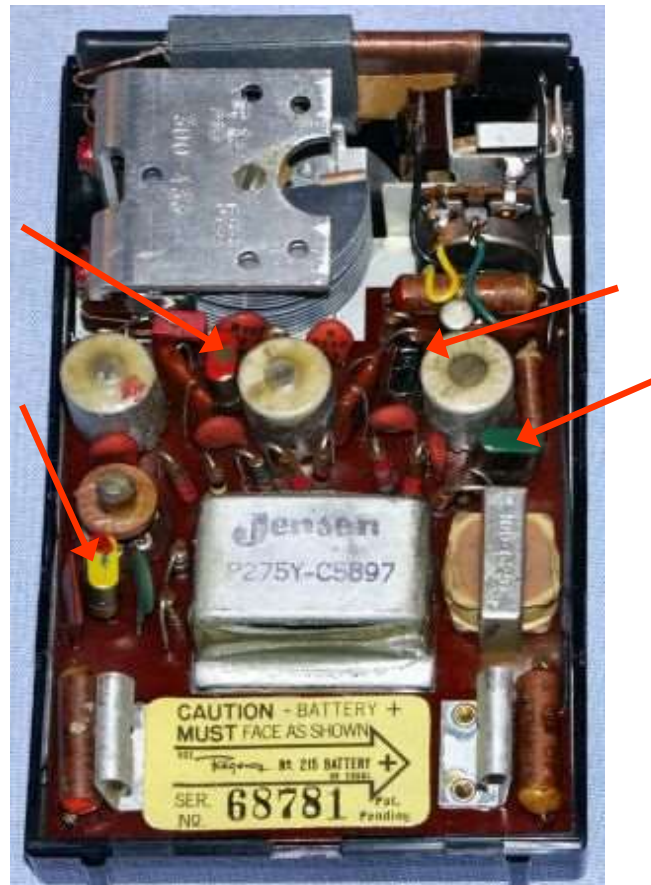
Première radio (4 transistors), Regency TR1, 1954
